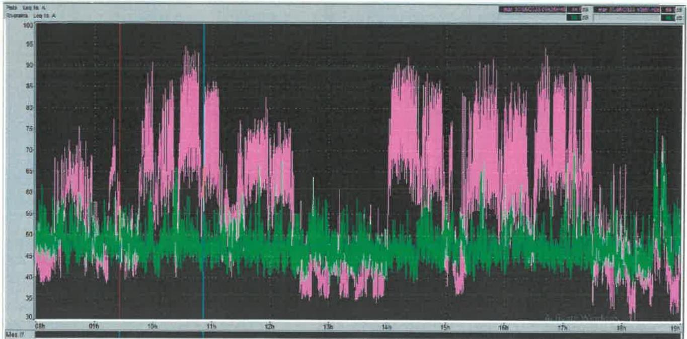
Ouverture du circuit : Mesures et Analyses réalisées selon méthode contrôle stipulée dans la norme NFS 31-010 et ce en 2 points simultanément : au dessus de la ligne d'arrivée du circuit et au centre de Ledenon.
